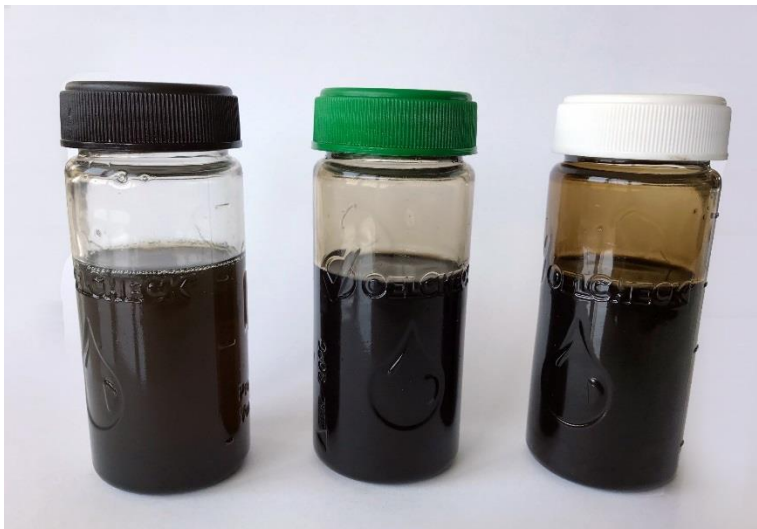
Bild 3: Schmieröle mit Grau- oder Schwarzfärbung
