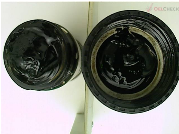
Bild 1: Eingedicktes Diesel-Motorenöl nach nur 150 Bh, ©OELCHECK GmbH
