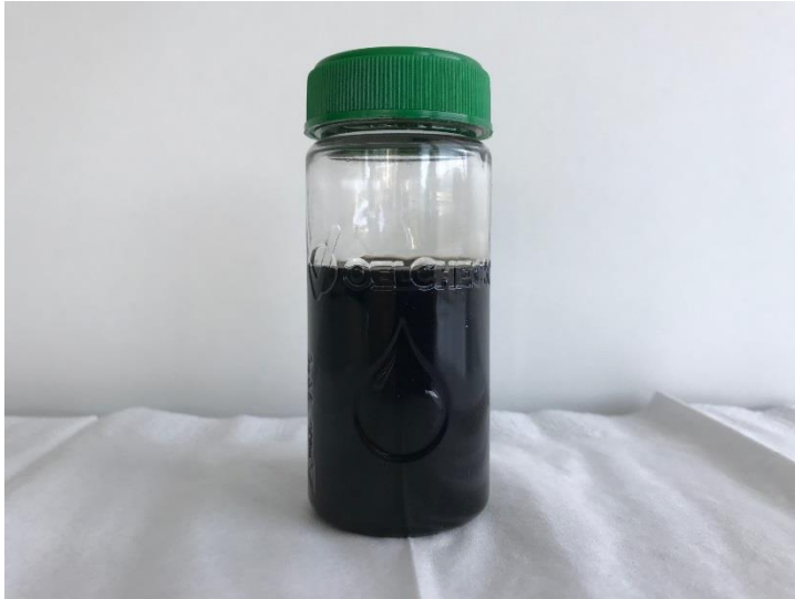
Bild 3: Schwarz gefärbtes Hydrauliköl aus einem Mobilbagger, © OELCHECK GmbH
