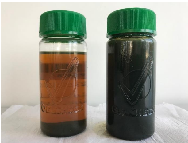
Bild 4: Schwarzer Bodensatz im Achsgetriebe-Öl (rechte Probe aufgeschüttelt), © OELCHECK GmbH
