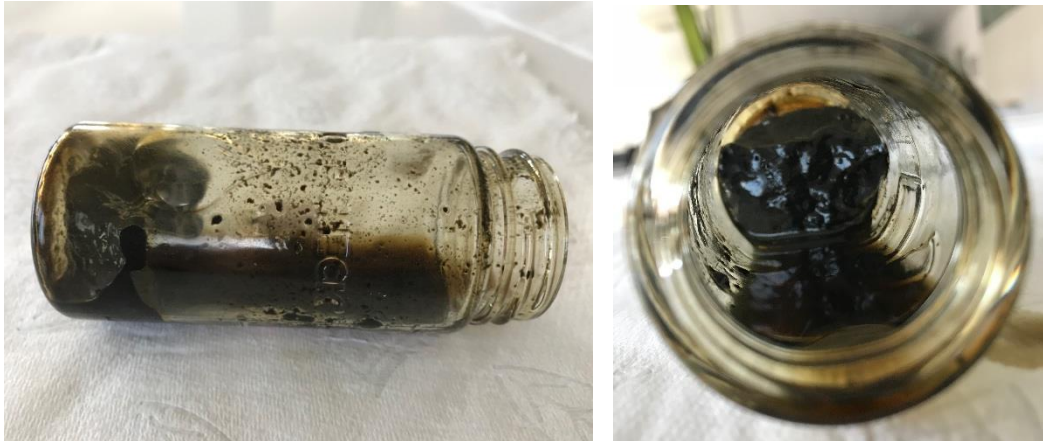
Bild 2: Geleeartige Eindickung eines Dieselmotorenöls ©OELCHECK GmbH
